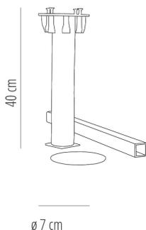
**DES MESURES****H** 40cm x  $\varnothing$  7cm**H** 15.75in x  $\varnothing$  2.76in**CARACTÉRISTIQUES**
